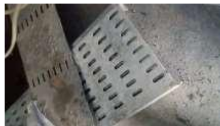
Gambar 3.29. Cable Tray(Sumber : Dokumentasi Penulis,2022)
