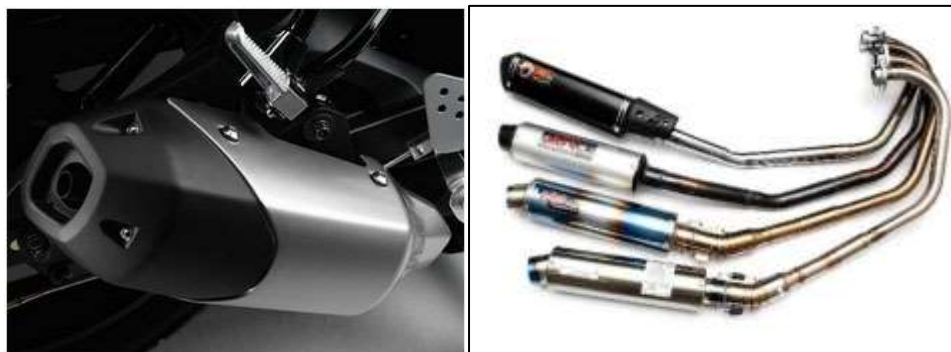
Gambar 2. Perbedaan knalpot standar pabrik dan knalpot balap.
