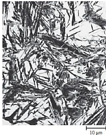
Gambar 8. Struktur mikro martensit. Bentuk jarum (fase martensit), dan daerah putih (austenite). (Avner, Sidney H. 1974:258)
