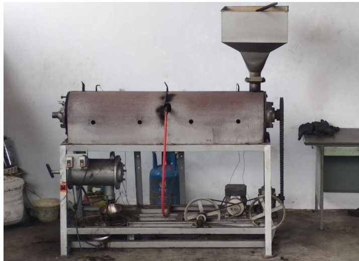
Gambar 3.1 Reaktor torefaksi kontinu tipe tubular dengan sistem pemanas oil jacket .
