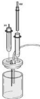
Gambar 2. Sel Voltammetri, W: Elektroda kerja, R : Elektroda pembanding, A : Elektroda bantu (Monk, 2001)
