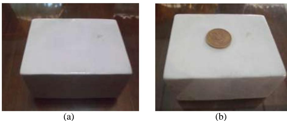
Gambar 3.2 Balok kayu mahoni (a) real ukuran balok kayu dengan menggunakan koin sebagai skala pembanding
