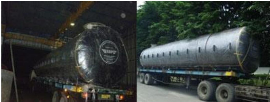
Gambar 2.2. Bentuk Fisik Underground Tank SPBU Pertamina (Sumber : CV. Sinar Baru Perkasa, 2012)
