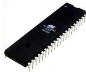
Gambar 2.5 Bentuk fisik mikrokontroler Atmega32
