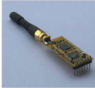
Gambar 2.13 Bentuk fisik radio frekuensi APC220
