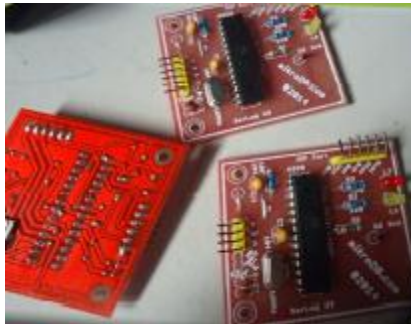
Gambar 2.9 Bentuk fisik modul serial logger
