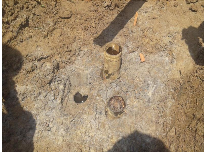
Gambar 3.2. Pengambilan contoh tanah asli.
