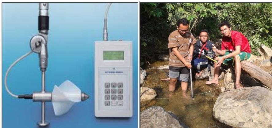
Gambar 4. *Currentmeter* dan pengukuran kedalaman dan kecepatan aliran
