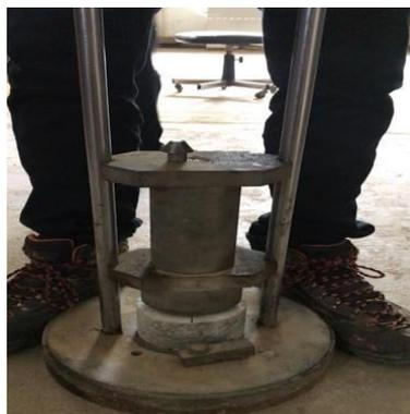
Gambar 3.26. Pengujian kuat kejut atau *impact*.
