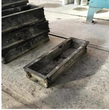
Gambar 3.11. Cetakan balok 150 x 150 x 600 (mm).
