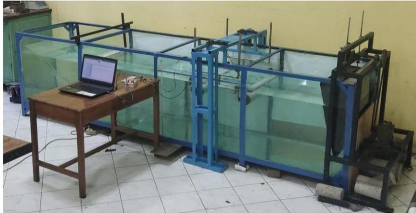
Gambar 3.9 Rangkaian Kolam Pengombak.
