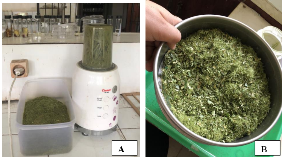
Gambar 4. Pembuatan ekstrak. (A) Penghalusan daun menggunakan blender; (B) Pengayakan daun menggunakan ayakan 40 mesh.
