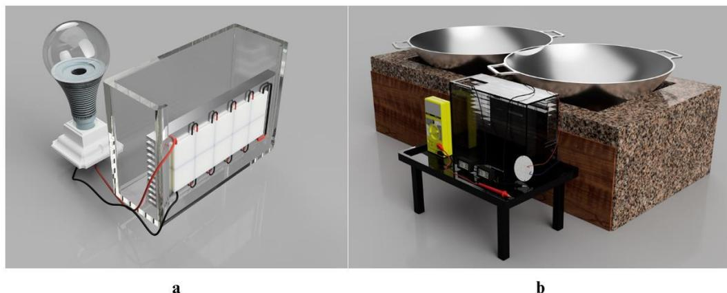
**Gambar 3.3.**(a) Desain alat generator termoelektrik dengan TEC 12706 dan (b) Desain realisasi generator termoelektrik.
