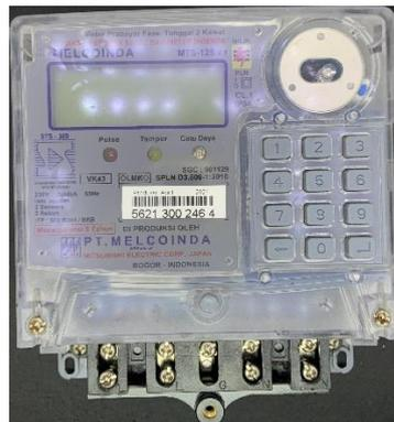
Gambar 2.1 Kwh meter digital satu fasa
