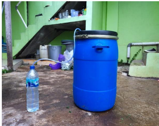
Gambar 3. Pembuatan pupuk organik cair urine kambing, daun kelor, dan batang pisang dengan metode anaerob
