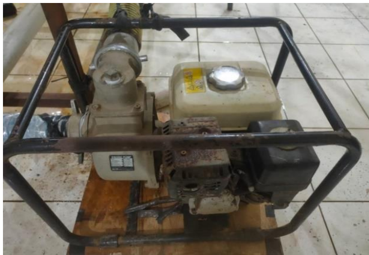
Gambar 3.17 Mesin pompa air
