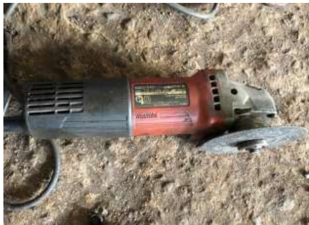
Gambar 3. 3 Mesin gerinda tangan
