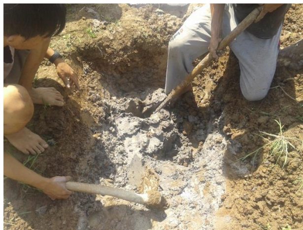
Gambar 3.3. Pengambilan sampel tanah terganggu
