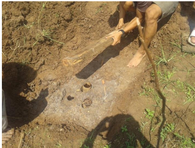
Gambar 3.2. Pengambilan sampel tanah asli
