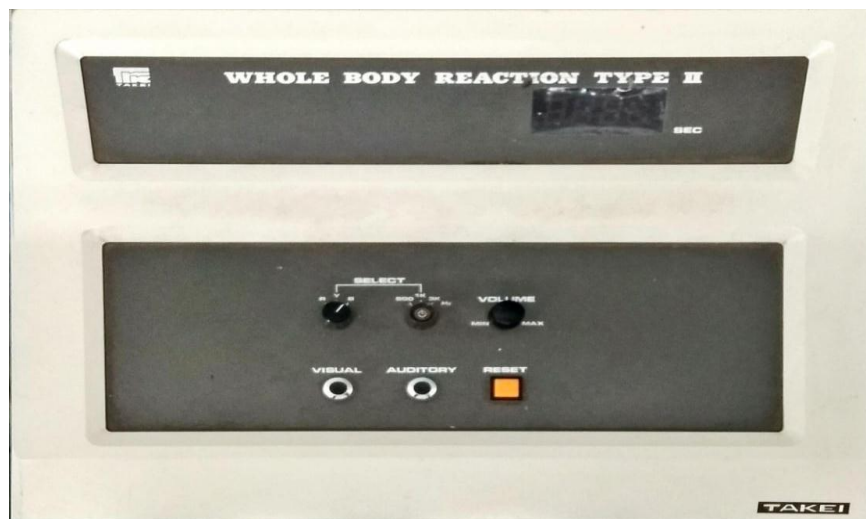
Gambar 3.4 Alat Tes Kecepatan Reaksi ( Whole Body Reaction ) (Sumber: Lab Penjas Unila)
