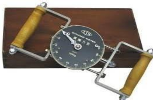
Gambar 3.2 Push and Pull Dynamometer (Sumber: Wiriawan, 2017: 54)
