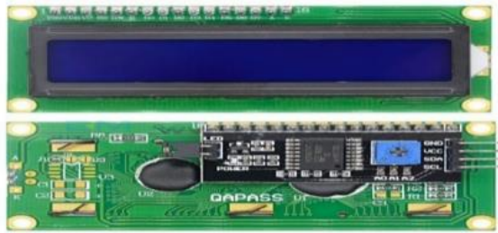
Gambar 2. 9 Modul LCD I2C 16x2
