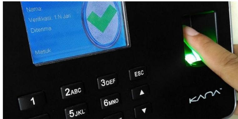
Gambar 2.4.1 Contoh alat sistem absensi menggunakan identifikasi sidik jari
