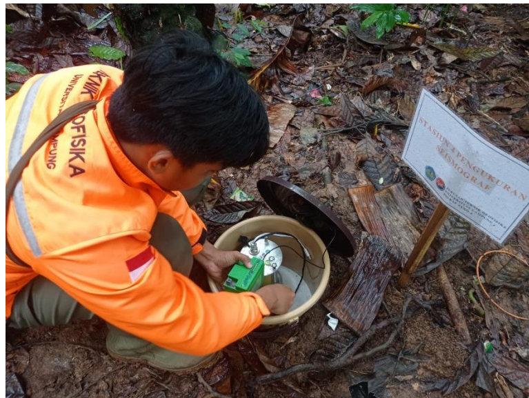
Gambar 16. Akuisisi data dan penggantian accu
