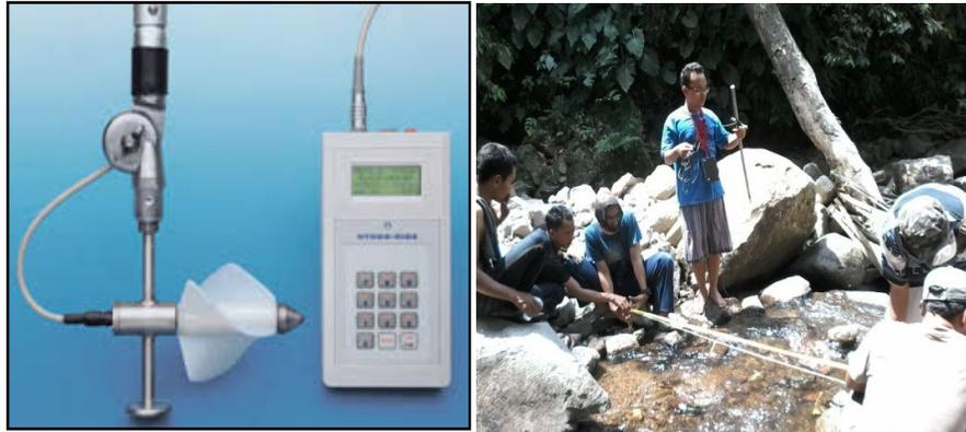
Gambar 3.2 *Current* meter dan pengukuran kedalaman dan kecepatan aliran
