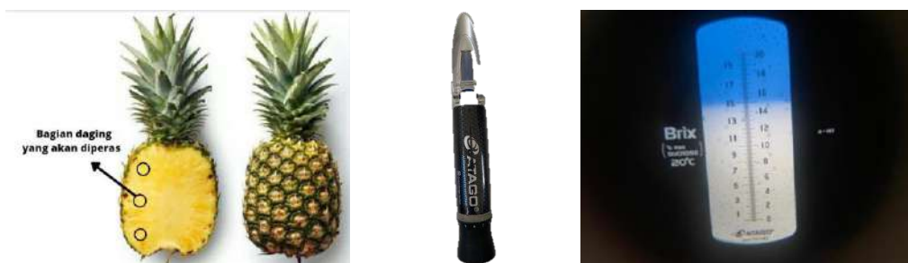
Gambar 5. Ilustrasi bagian daging yang akan diteteskan ke refraktometer
