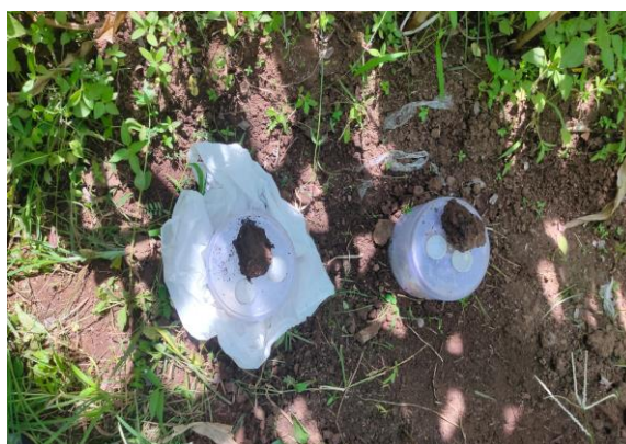
Gambar 3. Sketsa Pengukuran respirasi tanah di lapang. kiri: kontrol (a) ; kanan: perlakuan (b).
