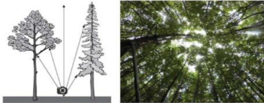
a. Ilustrasi metode hemispherical photography untuk mengukur tutupan mangrove
