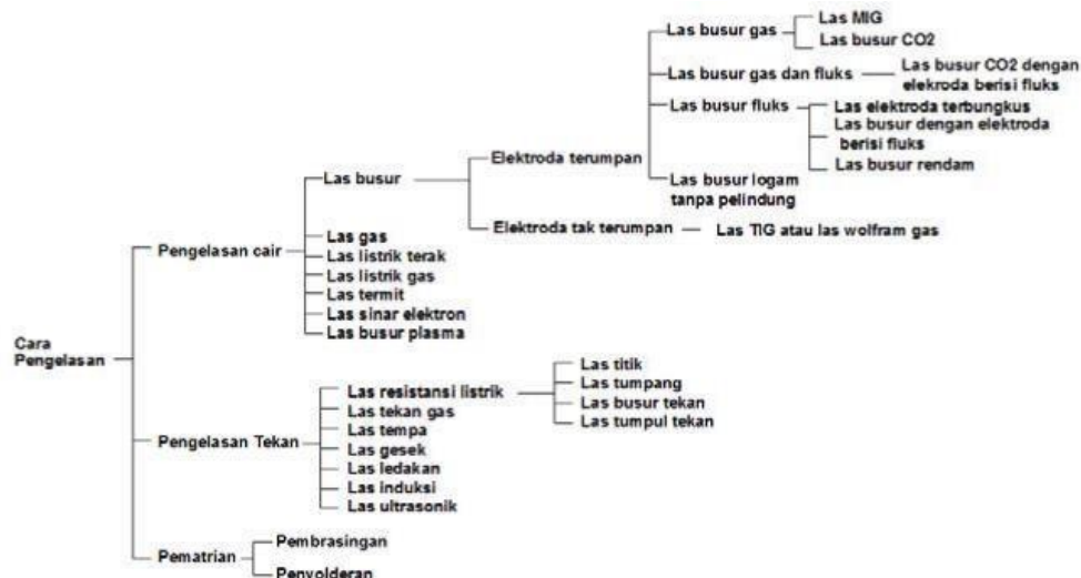
Gambar 2.1 Klasifikasi cara pengelasan Sumber : (Lamidi, 2020)
