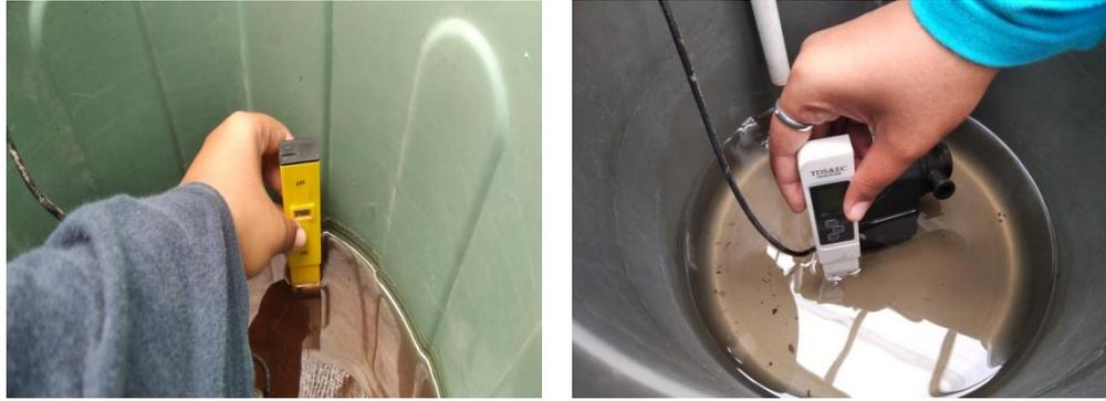
Gambar 7. Pengukuran pH, kepekatan larutan, EC, dan suhu larutan
