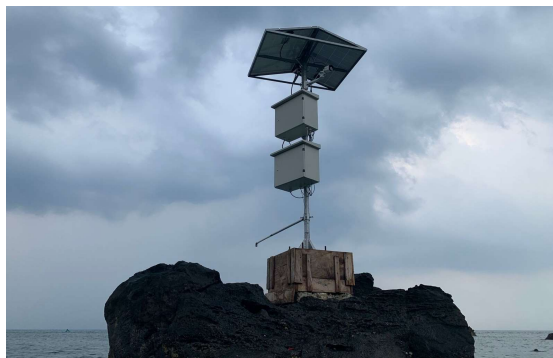
Gambar 1 Perangkat sistem pemantauan dan peringatan bencana yang ditempatkan di Pantai Canti, Kalianda, Lampung Selatan.
