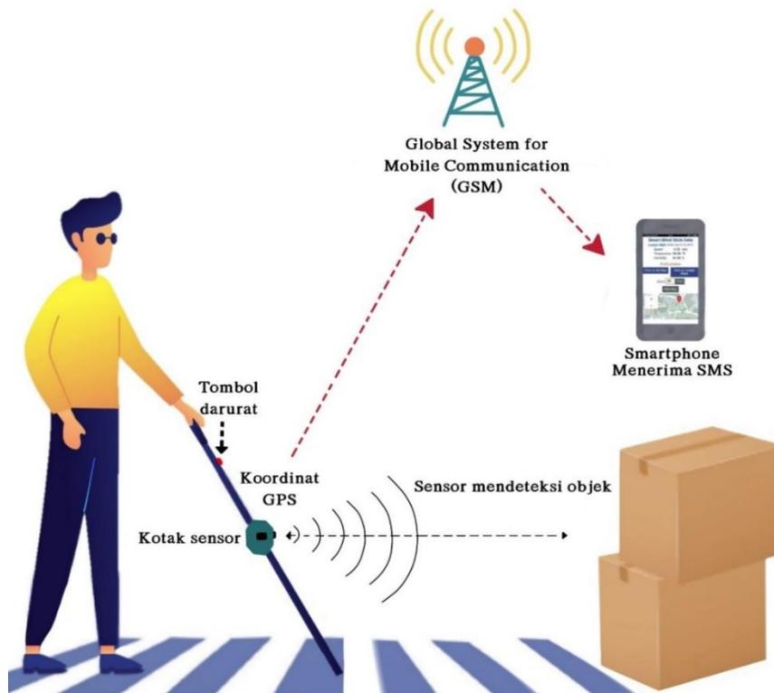
**Gambar 3.6 Ilustrasi pengaplikasian alat bantu tunanetra**
