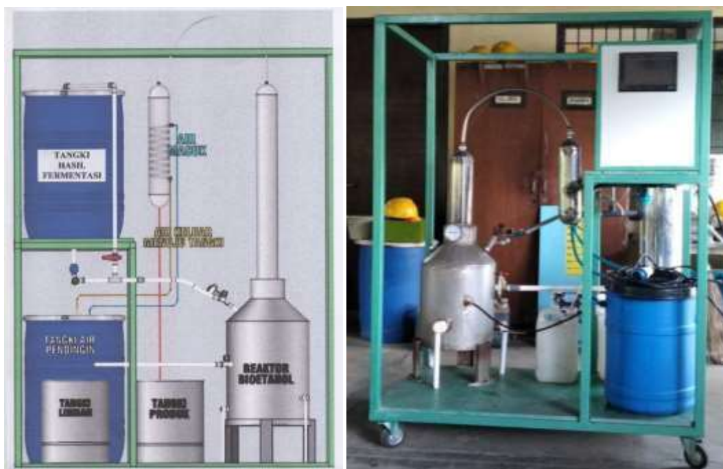
Gambar 3.3. Desain reaktor dan realisasi alat penelitian.
