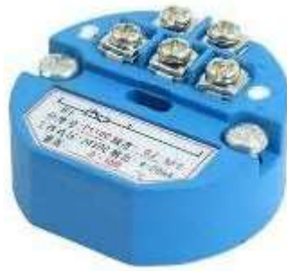
Gambar 2.22. Temperature transmitter suhu 0-150°C, 4-20mA, 24 Volt.
