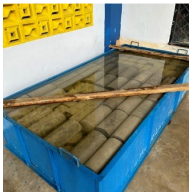
Gambar 14. Proses perendaman benda uji
