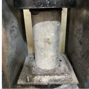
Gambar 15. Pengujian kuat tekan pada beton
