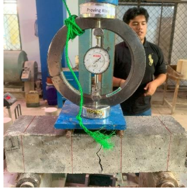
Gambar 16. Pengujian kuat tarik lentur dengan alat Hydraulic Jack dan Proving Ring dalam Loading Frame .
