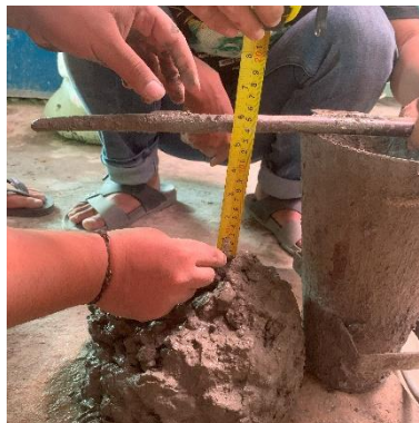
Gambar 13. Pemeriksaan workability menggunakan kerucut abrams .
