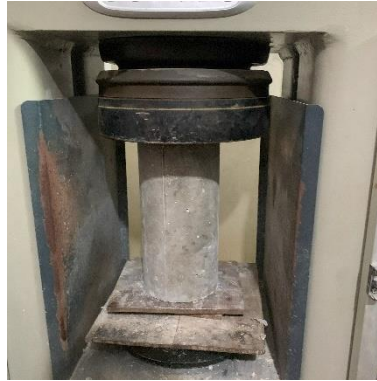
Gambar 15. Pengujian kuat tekan dengan alat CTM.
