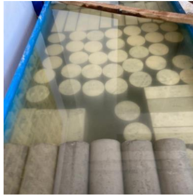
Gambar 14. Proses curing pada bak perendam.
