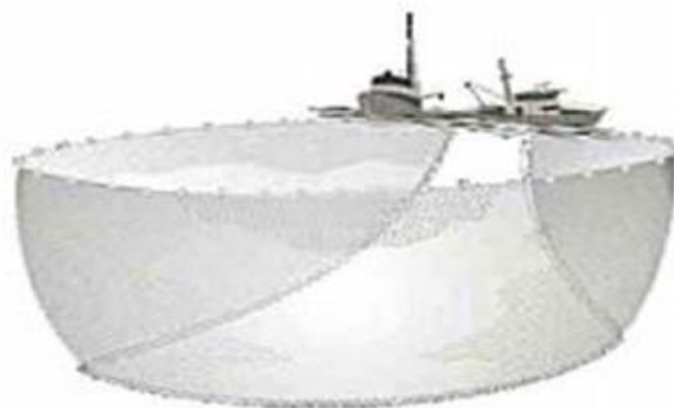
Gambar 4. Alat tangkap purse seine Sumber : (Damayanti, 2020)
