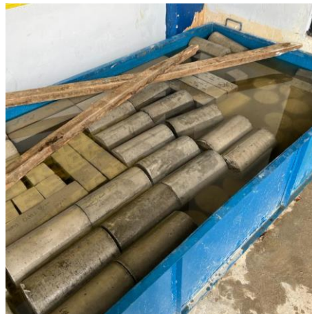
Gambar 3. 3 Perawatan benda uji
