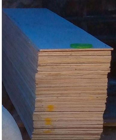
Gambar 3.5. Plywood Sumber: Dokumentasi Lapangan
