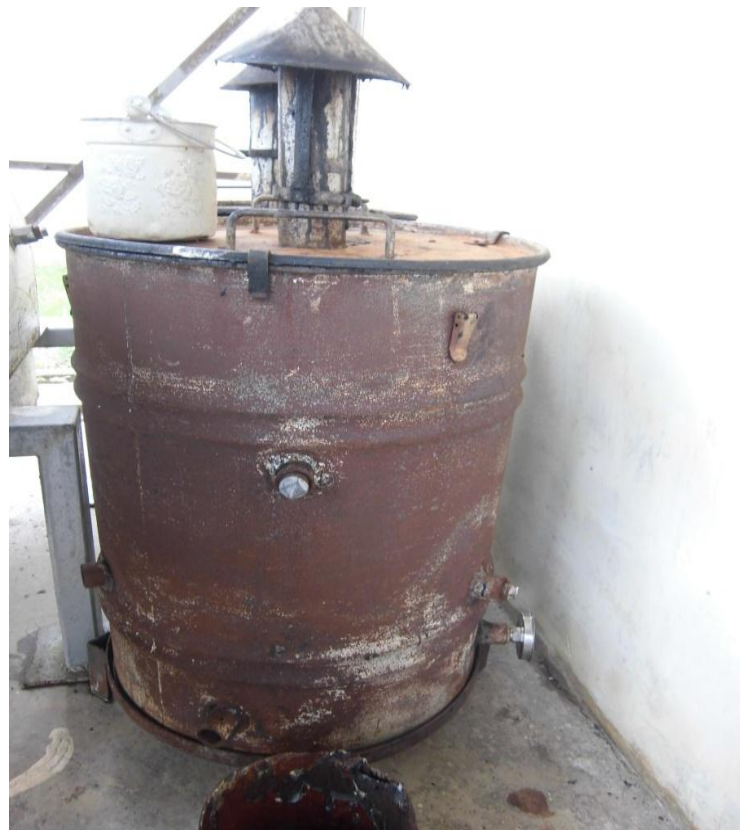
Gambar 1. Pirolisator untuk pembakaran sekam padi.
