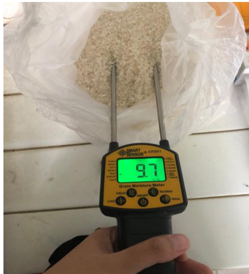
Gambar 6. Pengukuran kadar air (Sumber: Dokumentasi pribadi).
