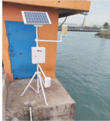
Gambar 2.3 Implementasi sistem tide gauge (Sutanto, 2019)
