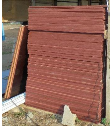
Gambar 3. 7 Multiplek Plywood Sumber : Dokumentasi Lapangan
