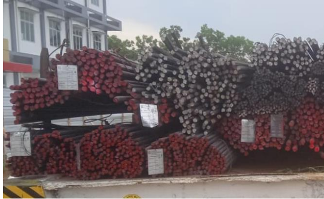
Gambar 3. 3 Besi Beton Sumber : Dokumentasi Lapangan
