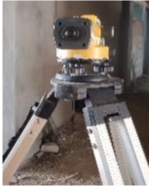
Gambar 3. 17 Waterpass Sumber : Dokumentasi Lapangan
