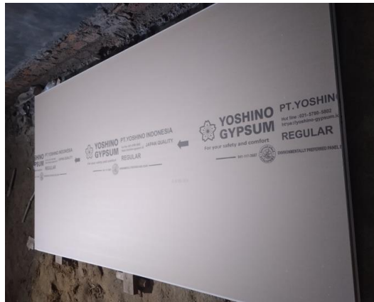
Gambar 3.23 Plafond gypsum Sumber: Foto Lapangan
