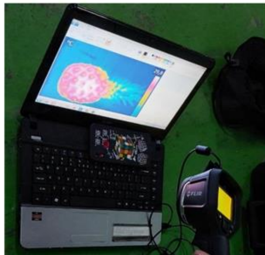
Gambar 4. Ilustrasi kamera FLIR E4 (kiri) dan pengukuran suhu thermal pada buah nanas (kanan)
