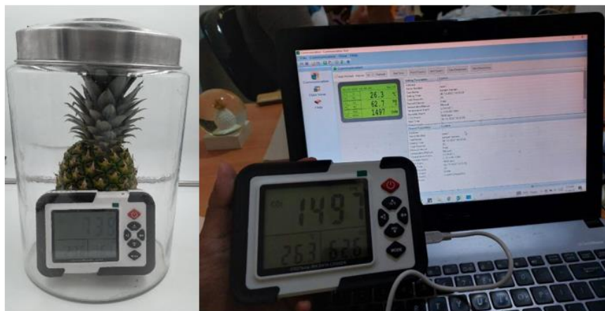
Gambar 2. Ilustrasi pengukuran laju respirasi buah nanas
