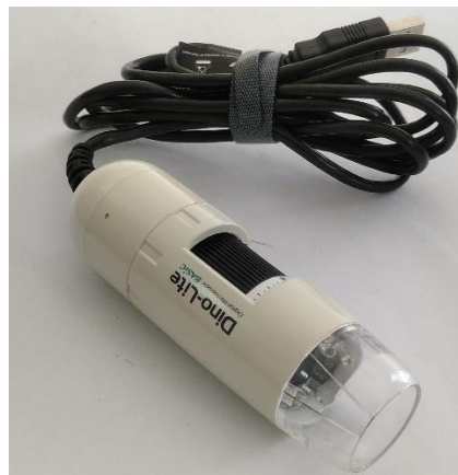
Gambar 3. 5 Kamera Mikroskop USB Merk DinoLite
