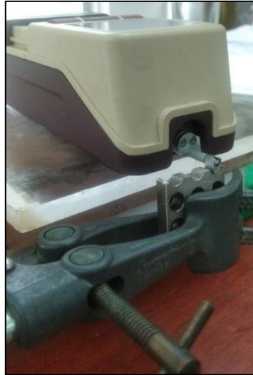
Gambar 3. 12 Pengukuran kekasaran permukaan menggunakan Surface Roughness Tester
