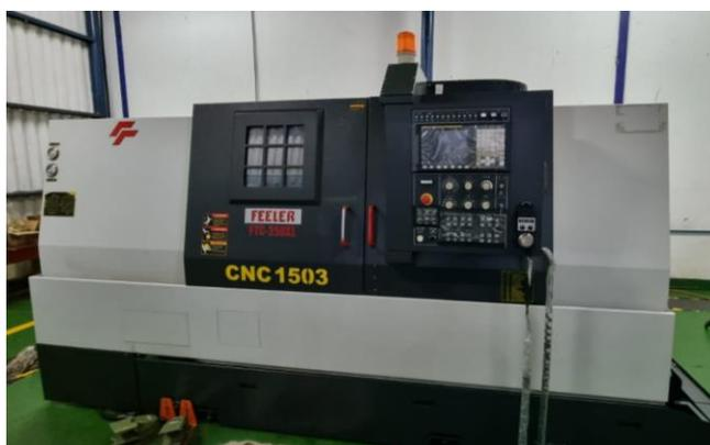
Gambar 3. 1 Mesin Bubut CNC
