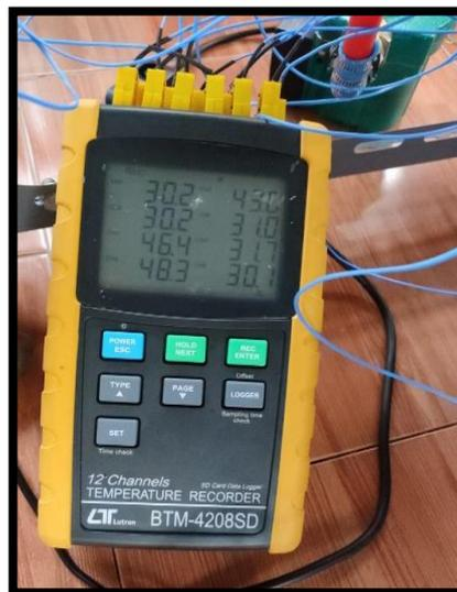
Gambar 3. 3 *Data Logger* dan Termokopel
