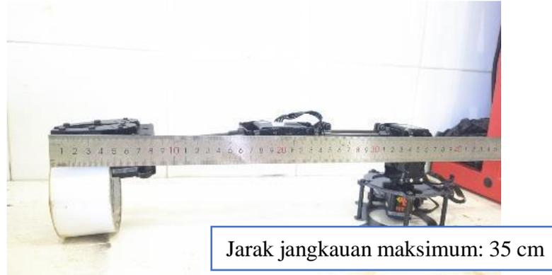
Gambar 2.2 Perhitungan jarak jangkauan maksimum
