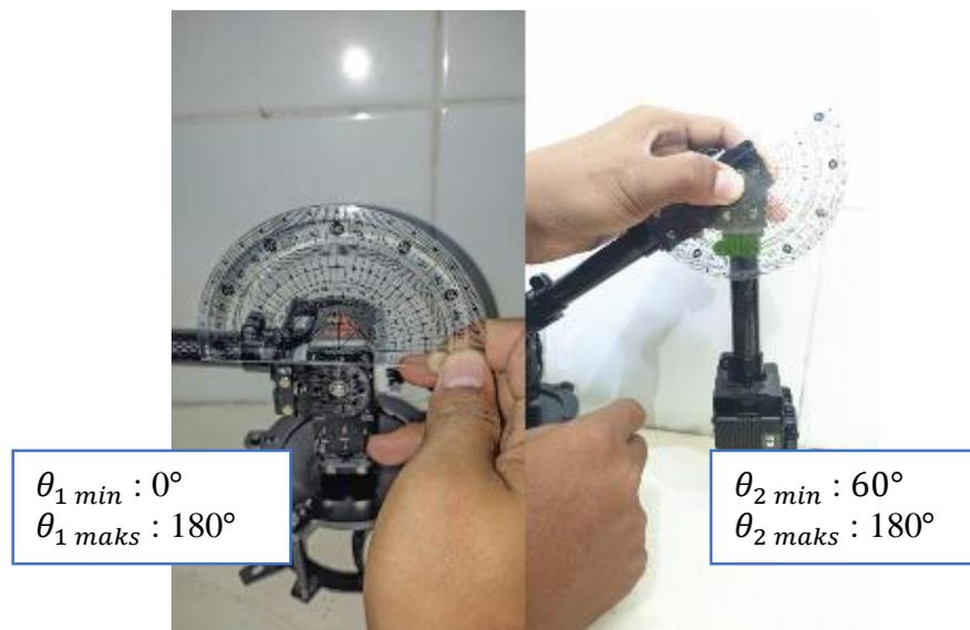
Gambar 2.8 Pengukuran Sudut  $\theta_{1 \max}$  dan  $\theta_{1 \min}$  serta Sudut  $\theta_{2 \max}$  dan  $\theta_{2 \min}$
