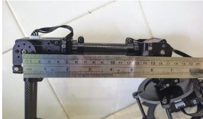
Gambar 2.12 Pengukuran panjang link 1
