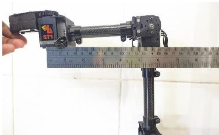
Gambar 2.13 Pengukuran panjang link 2
