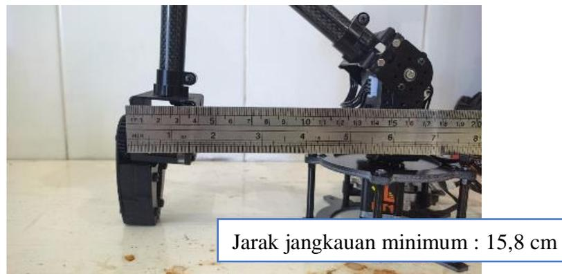
Gambar 2.3 Perhitungan jarak jangkauan minimum
