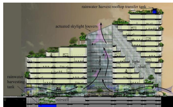
Gambar 2.30 Simulasi Pergerakan Udara dalam Bangunan
