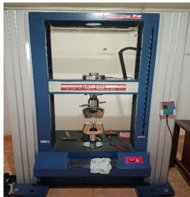
Gambar 3.14 Alat pengujian tarik
