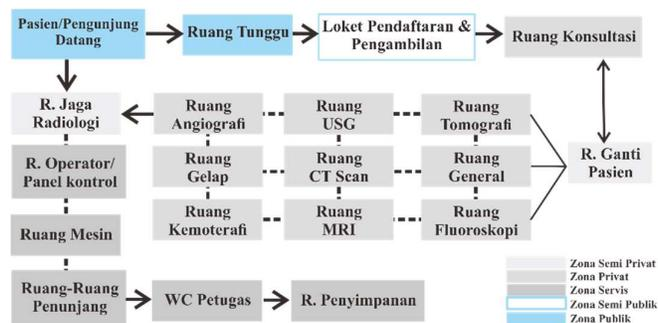
Gambar 4.29. Diagram Ruang Instalasi Radiodiagnostik
